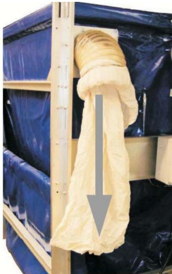
Im Falle einer einer unsachgemäßen Befüllung, entsteht innerhalb des staubdichten Silos ein Überdruck, wodurch der Silo beschädigt werden kann. Als Sicherheitsmaßnahme ist der Staubbeutel zu verwenden, der bei Bedarf zur Entlastung führt.
