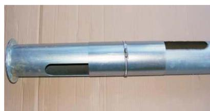
3. Schale mit Schlauchbinder sichern
