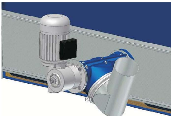
Entfernen Sie, falls vorhanden, das Fußteil einschließlich Lagerbolzen, von der "ersten" Förderschnecke. Bitte achten Sie darauf, dass diese "erste" Schnecke im Fußteil eine engere Wendelsteigung aufweist. Anmerkung: Alle Folgeschnecken, welche mit dem Fußteil für Schlauchkupplungen in Serie folgen, müssen konstante Wendelsteigung aufweisen.
