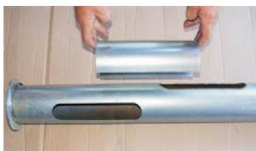
2. Schale aufstecken und mittig ausrichten, so dass die Einlassschlitze zur Hälfte geschlossen sind
